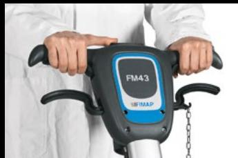
Elle est équipée d'un double système de sécurité qui permet à la machine de se mettre en marche seulement par la pression des leviers du guidon et par l'activation simultanée du bouton de présence opérateur. La machine s'arrête dès que l'opérateur relâche les leviers
